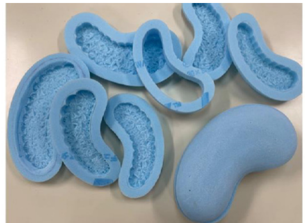
写真 1 スタイロフォームによる試作モデルの制作
