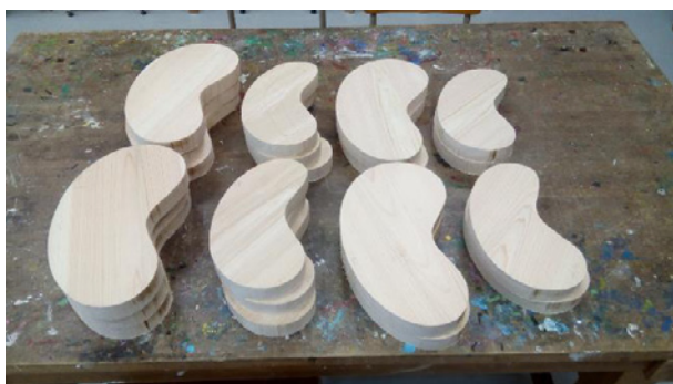
写真2 切り抜いた3層構造と2層構造ヒノキ材
