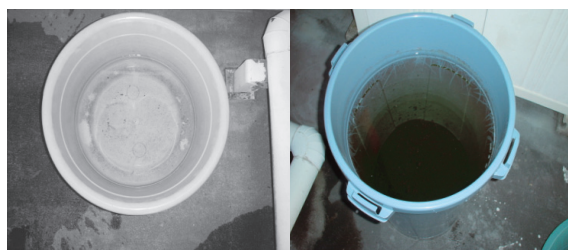
図 2 図は大学屋上に設置された雨水採取用桶であり、左は降雨採取用、右は雨水貯水用である。降雨直後は無色透明であるが、貯蔵雨水は時間とともに藻類が発育し、緑色に変化する。
