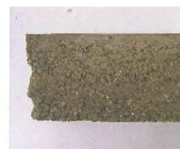
図 - 14 破壊状況 (半水中凍結半水中融解)
