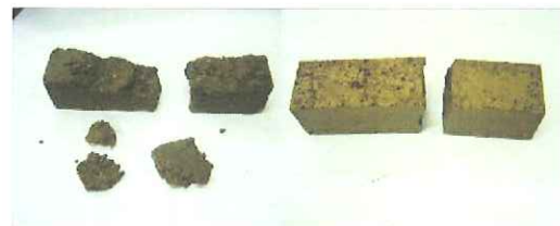
図 - 13 破壊状況 (左・右: 水中凍結水中融解)
