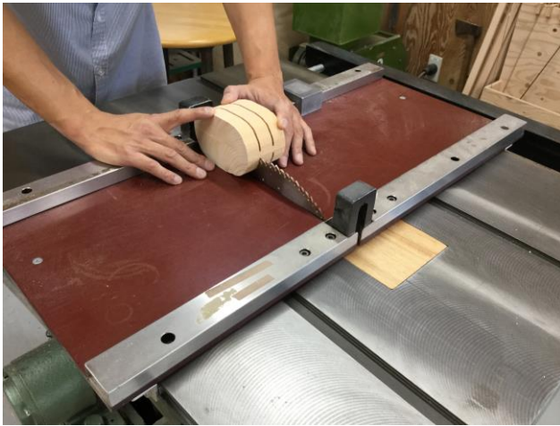
写真 11 昇降盤による切断
