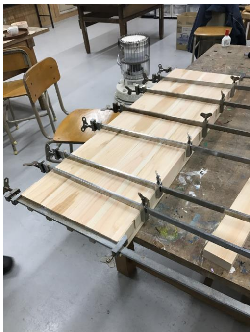
写真5 レーン部分の圧着
