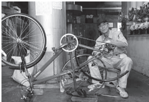
<写真1> 校務員による自転車の修理、ブレーキ調整
