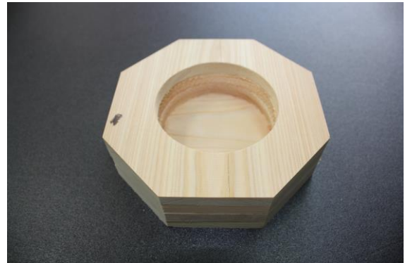
②正方形の板3枚を接着し、ホールソーで穴を開け、底板を接着後、丸鋸で周囲をカットする。
