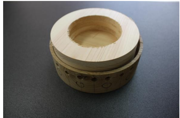
④穴の位置を決め、側面にドリルで穴を開けた後、旋盤でうつわの内側を削る。
