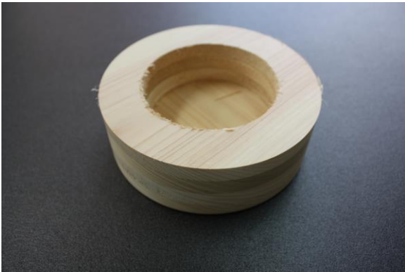
③旋盤で外側を削る。
