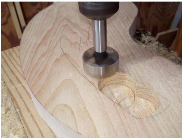
写真4 ボール盤でくり抜く(上下層)
